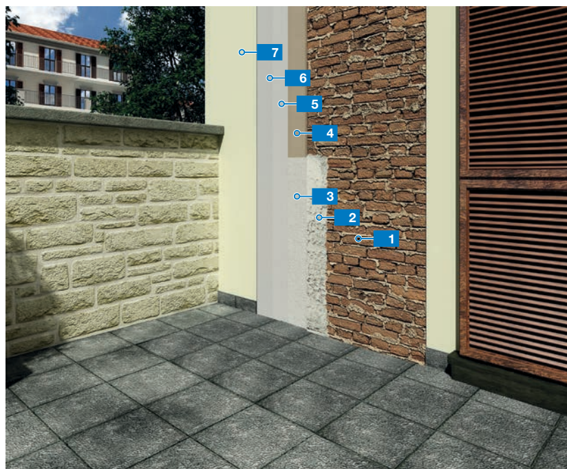
HEMA 3: Sanacija dviga kapilarne vlage z izdelki iz linije Mape-Antique.
